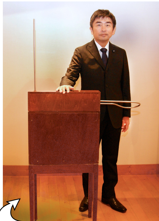
テルミン：ロシアの天才物理学者レフ・テルミンによって 考案された世界最古の電子楽器。2本のアンテナから 発する電波を制御し、楽器に触れることなく演奏する。
